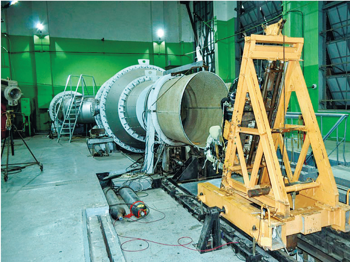
Аэродинамический стенд для продувки катапультных кресел и снаряжения летчиков
